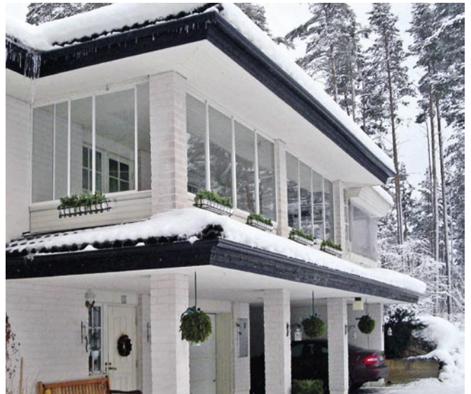
Sami-parvekelasijärjestelmät toteutetaan 1k-lasilla tai 2k-eristyslasilla. Käyttökohteita ovat mm. kuistit, terassit, parvekkeet, liukuväliseinät, liukuovet ja suihkuseinät.
