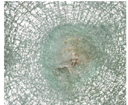
Kuvan P7B polycarbonat vahvistaiseen mur- ronsuojalasiin lyötiin palomiesten kirveellä ja viiden kilon lekalla yhteensä yli 100 kertaa. Minkäänlaista murtoaukkoa ei syntynyt.
