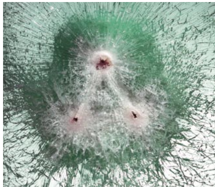
Luodinsuojalaseihin ammutaan testeissä kolmion muotoon kolme laukausta 120 mil- limetrin alueelle.
